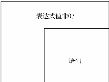
图 4-2 while 循环结构的 N-S 图
