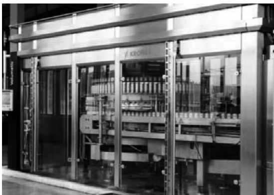
图 1-2 自动化生产线在啤酒灌装中的应用
