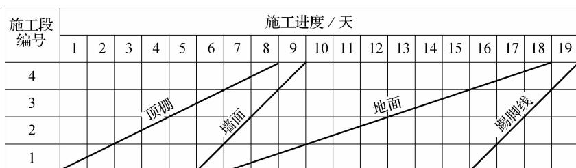
图 2-9 流水施工垂直图表的具体形式
