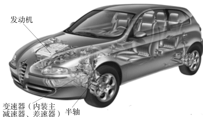
图 1-6 发动机前置前轮驱动
