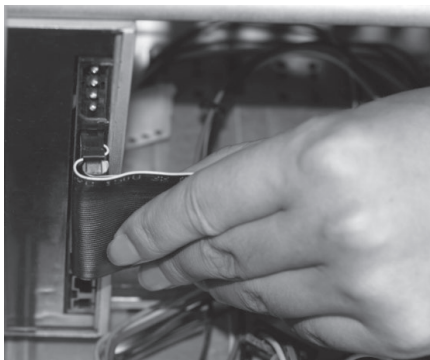
图 2-31 插入光驱数据线
