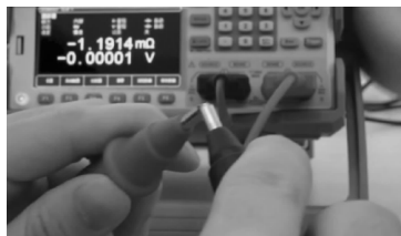
图 1-18 皇冠探头测试棒清零
