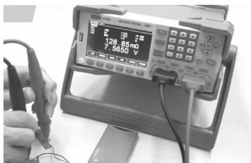
图 1-19 开尔文测试线清零
