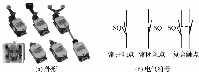
图 1-15 行程开关的外形与电气符号
